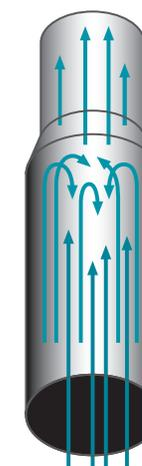
Querschnittsreduzierungen führen aufgrund des Anstiegs der Strömungsgeschwindigkeit auch zur Erhöhung des Geräuschpegels.
