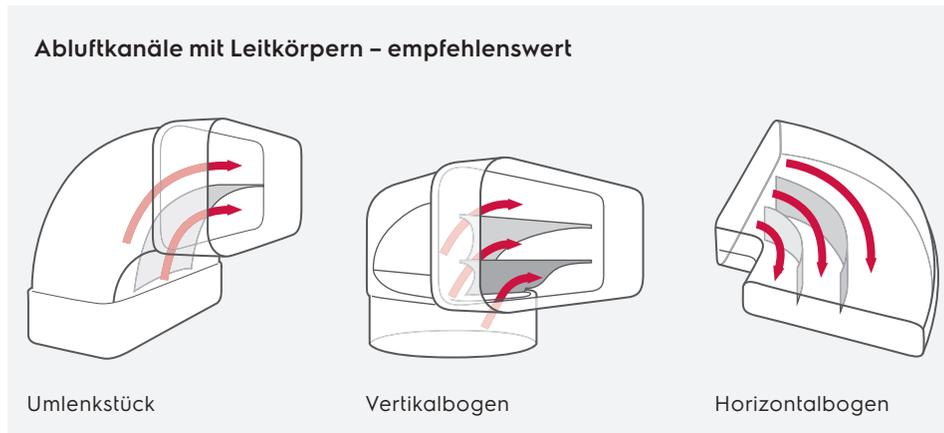
Durch Leitkörper/-bleche in Kurven und Bögen kann der Luftstrom kontrolliert geführt und störende Verwirbelungen vermieden werden. Im Vergleich zu herkömmlichen Bögen gehen bei Flachkanälen bis zu 79 % und bei Rundkanälen bis zu 70 % weniger Druck verloren.
