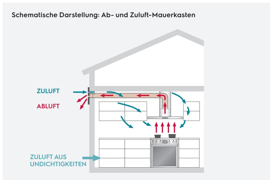
Mauerkästen sind in folgenden drei Hauptnennweiten (Nennweite = NW) erhältlich: NW 200 mm/150 mm/125 mm. Notfalls kann die Nennweite des Mauerkastens größer sein als die der vorgelagerten Abluftleitung und mithilfe eines
