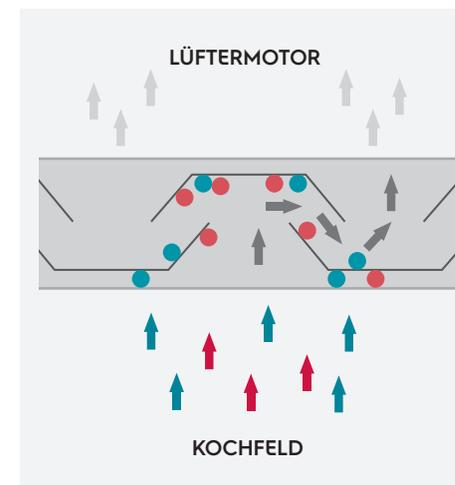
Der Labyrinthfilter sollte wie der Maschenfilter gereinigt werden: entweder von Hand oder im Geschirrspüler im Intensivprogramm (65-70 °C) und ohne zusätzliches Geschirr. Da er ausschliesslich aus Edelstahl besteht, treten im Vergleich zu Filtern aus Aluminium keine Verfärbungen auf.
