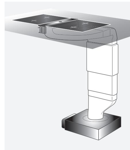
Ein Muldenlüfter wird in die Arbeitsplatte zwischen oder neben den Kochfeldern bzw. Kochfeldmodulen eingebaut. Bei dieser Gerätetechnik wird der Wrasen nach unten abgesaugt. Durch den Dunstabzug wird eine Querströmung über dem Kochfeld erzeugt. Dieser Luftstrom saugt den Kochdunst ab, bevor er steigen kann. Wichtig ist hierbei, dass die Kochzonen direkt an den/die Muldenlüfter grenzen.
